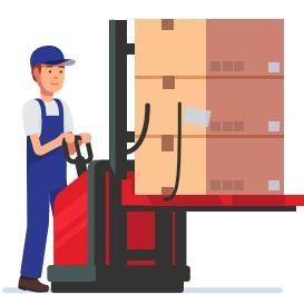
*Reach truck* adalah jenis *forklift* yang dirancang khusus untuk penggunaan di dalam gudang, terutama di area ruang sempit dengan rak-rak tinggi. *Forklift* ini memiliki desain yang lebih ramping dengan garpu yang bisa diperpanjang (*reach*) untuk mengambil barang dari rak-rak tinggi.
